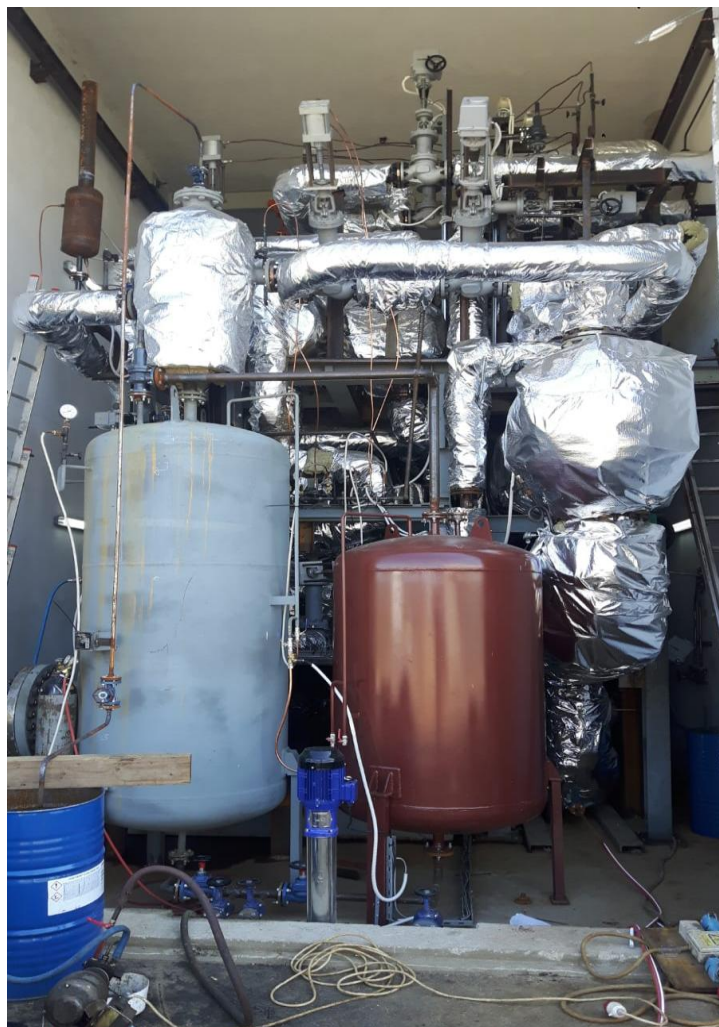
Slika 4: ORC modul kogeneracijskog postrojenja
